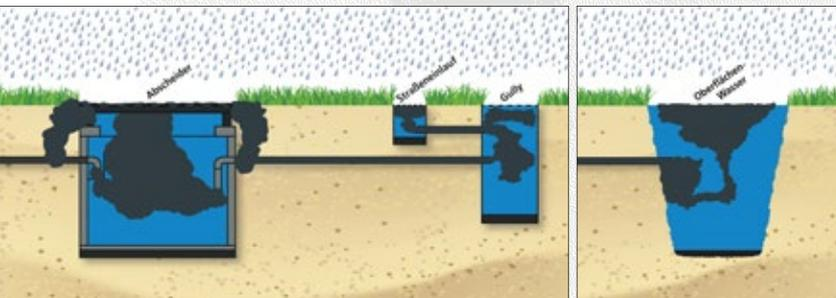
Das Quick Oil System (QOS) sorgt dafür, dass der Rückstand aus dem Abscheider in einem Behälter gesondert aufgefangen wird.
